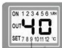
Рис. 9. Установка верхнего порога влажности.
