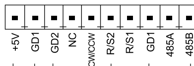
Схема расположения выводов для внешних сигналов управления DF600 Plus
