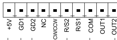
Схема расположения выводов для внешних сигналов управления DF600 Plus
